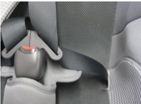
④最後まで通し終わると、タングの向きが変わり、腰側ハーネス部分のタングの反転が修復されます。
