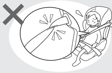
腰ベルトで骨盤がしっかりと拘束されるように必ず腰ベルトを低く下げて着用させてください。腹部に腰ハーネスがかかっていると、事故等の時に圧迫されるおそれがあります。
